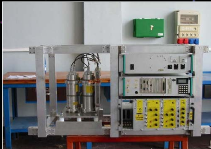
Lo strumento BaBy (Background Bypass) in fase di calibrazione presso i laboratori IASF-Palermo
